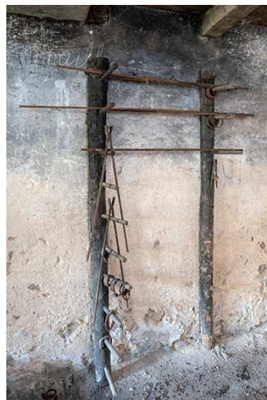
Forge : ratelier servant au stockage des barres de fer. Phot. Sonia Dourlot IVR43_20192501230NUC4A
