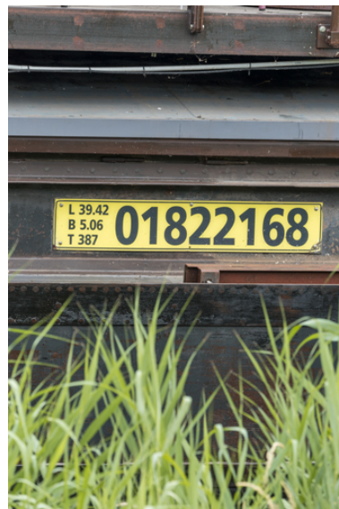
Plaque de jaugeage côté tribord. Phot. Pierre-Marie Barbe-Richaud IVR26_20238900630NUC4A
