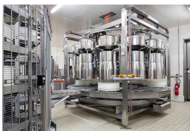
Installation de moulage (avec celle de pressage à gauche). Phot. Sonia Dourlot IVR43_20192500952NUC4A
