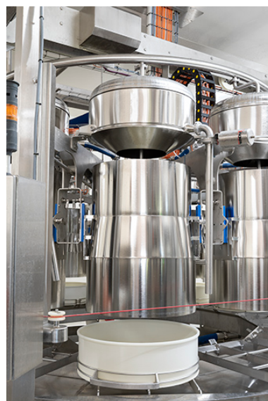
Installation de moulage. Pour une meule d'emmental (dont le diamètre est moindre que celle de comté), le corps central est retourné afin que sa petite section soit en bas. Phot. Sonia Dourlot IVR43_20192500953NUC4A
