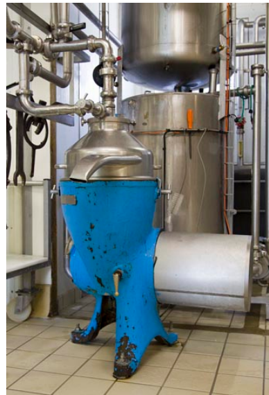
Écrémeuse Alfa-Laval. Phot. Yves Sancey IVR43_20132501223NUC2A
