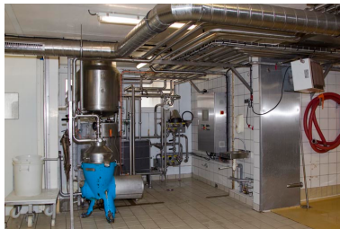
Écrémeuse et installation de dépotage du lait et refroidissement du sérum. Phot. Yves Sancey IVR43_20132501222NUC2A
