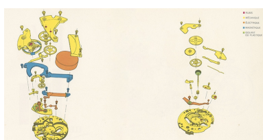
Eclaté d'un mouvement de montre Lip, 1969. IVR43_20212500082NUC2A
