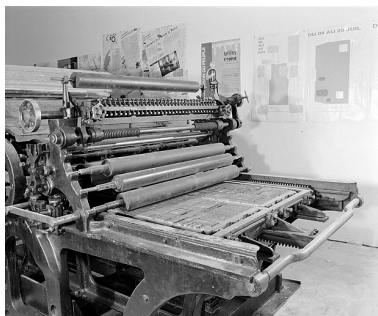
Partie avant de la machine. Système d'encrage vertical (encrier et rouleaux encreurs) à gauche, marbre portant une forme et sa composition à droite. Phot. Jérôme Mongreville IVR43_20023900363X
