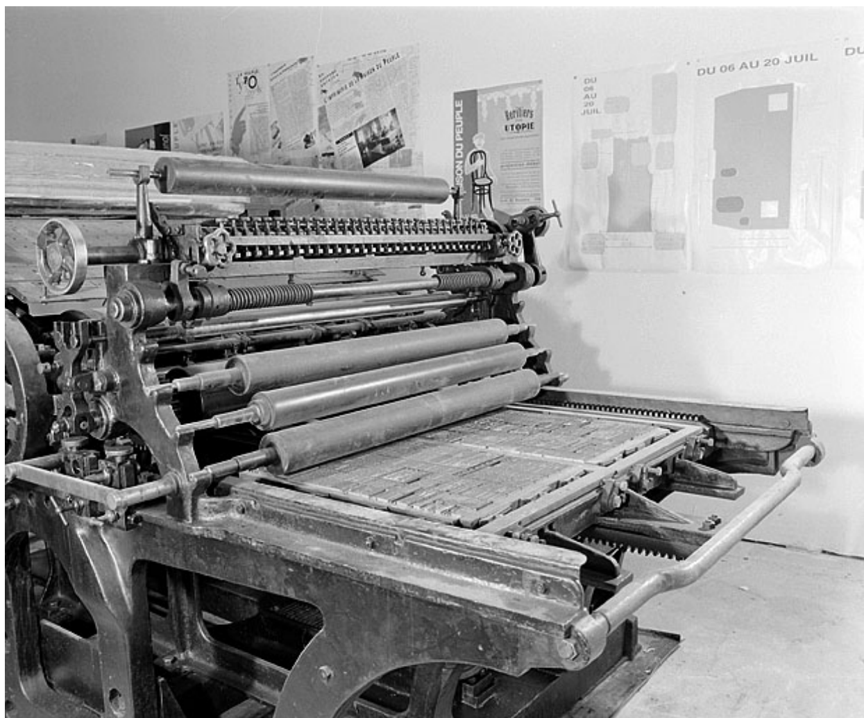
Partie avant de la machine. Système d'encrage vertical (encrier et rouleaux encreurs) à gauche, marbre portant une forme et sa composition à droite.
