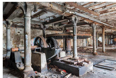
Rez-de-chaussée de l'atelier principal. Système de transmission de la turbine. Phot. Jérôme Mongreville IVR43_20152500385NUC4A
