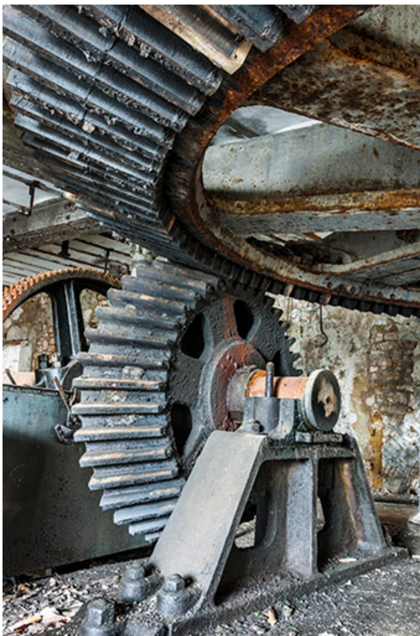
Rez-de-chaussée de l'atelier principal. Transmission par engrenages coniques de la turbine.
