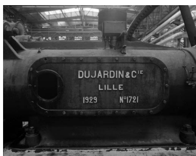
Soudière, salle des machines : pompe n° 4 vue de trois quarts. De gauche à droite : volant d'inertie, bielle (couvercle de protection enlevé), cylindre à vapeur, compresseurs. Phot. Yves Sancey IVR43_19893900418X
