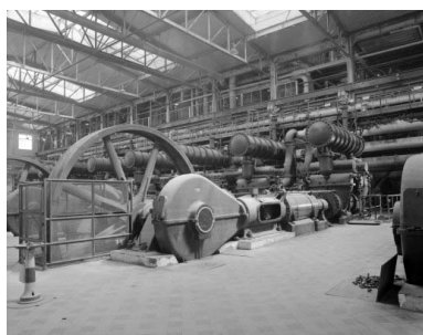
Soudière, salle des machines : pompe n° 4 vue de trois quarts. De gauche à droite : volant d'inertie, bielle (couvercle de protection enlevé), cylindre à vapeur, compresseurs. Phot. Yves Sancey IVR43_19893900418X
