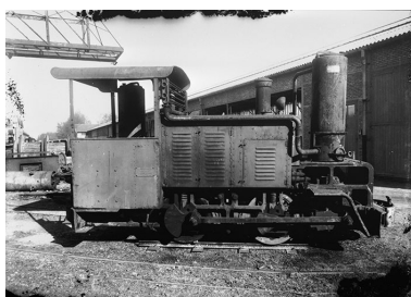
Locomotive Val de Maizet équipée d'un gazogène, vers 1942. Phot. Jérôme Mongreville, Phot. Charnotet
