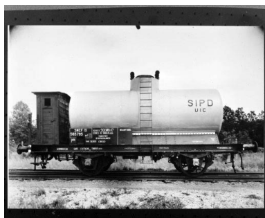
Wagon-citerne servant au transport d'hypochlorite. Phot. Jérôme Mongreville, Phot. Charnotet IVR43_19903900083X
