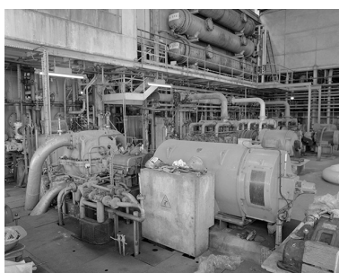
Soudière, salle des machines : arrière de la pompe n° 4. De gauche à droite : axe des compresseurs, compresseurs surmontés d'un séparateur d'humidité (réservoir cylindrique) puis cylindre à vapeur et bielle. Phot. Yves Sancey IVR43_19893900419X
