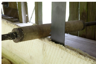
Détail de la scie du châssis. Phot. Jérôme Mongreville IVR43_20067000404NUCA
