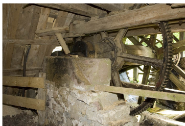
Etage de soubassement. Détail de la transmission par engrenage. Phot. Jérôme Mongreville IVR43_20067000406NUCA
