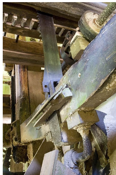
Etage de soubassement. Détail de la transmission : manivelle et lame de la scie vues du dessous. Phot. Jérôme Mongreville
