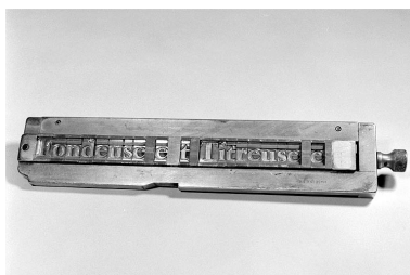
Face inférieure d'un composteur, matrices de caractères en place. Le caractère apparaît en négatif dans chaque matrice. Phot. Jérôme Mongreville IVR43_20023900096X
