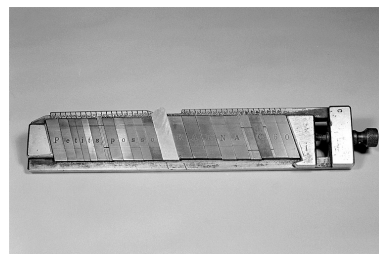
Face supérieure d'un composteur à matrices de caractères en italique. Le caractère apparaît au recto de chaque matrice. Phot. Jérôme Mongreville IVR43_20023900097X
