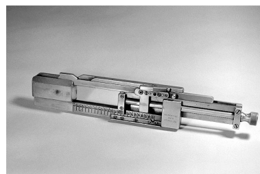
Composteur permettant le centrage des caractères sur la ligne. Phot. Jérôme Mongreville IVR43_20023900095X
