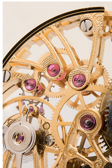
Détail : rubis et amortisseur de choc (à gauche). Phot. Sonia Dourlot IVR43_20182501154NUC4A
