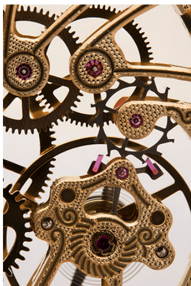
Détail : échappement à ancre (avec le coq au premier plan). Phot. Sonia Dourlot IVR43_20182501155NUC4A
