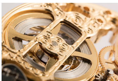
Détail : pont guilloché et ressort moteur. Phot. Sonia Dourlot IVR43_20182501153NUC4A
