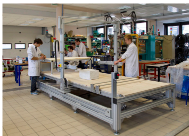
Bâtiment Coste : réalisation d'une découpeuse automatique par la section BTS CRSA (Conception et Réalisation de Systèmes automatiques), ex-MAI. Phot. Yves Sancey IVR43_20122500881NUC2A
