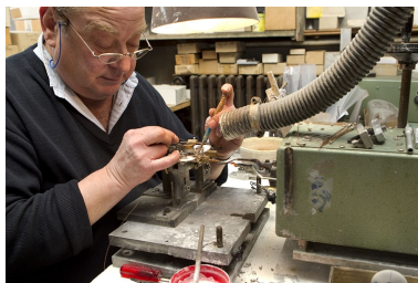
Soudage sur la machine à souder Himmel. Phot. Yves Sancey IVR43_20103900323NUC2A
