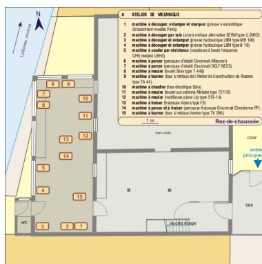
Atelier de mécanique : schéma de distribution des machines. Echelle 1:90. Dess. André Céréza IVR43_20113900030NUDA
