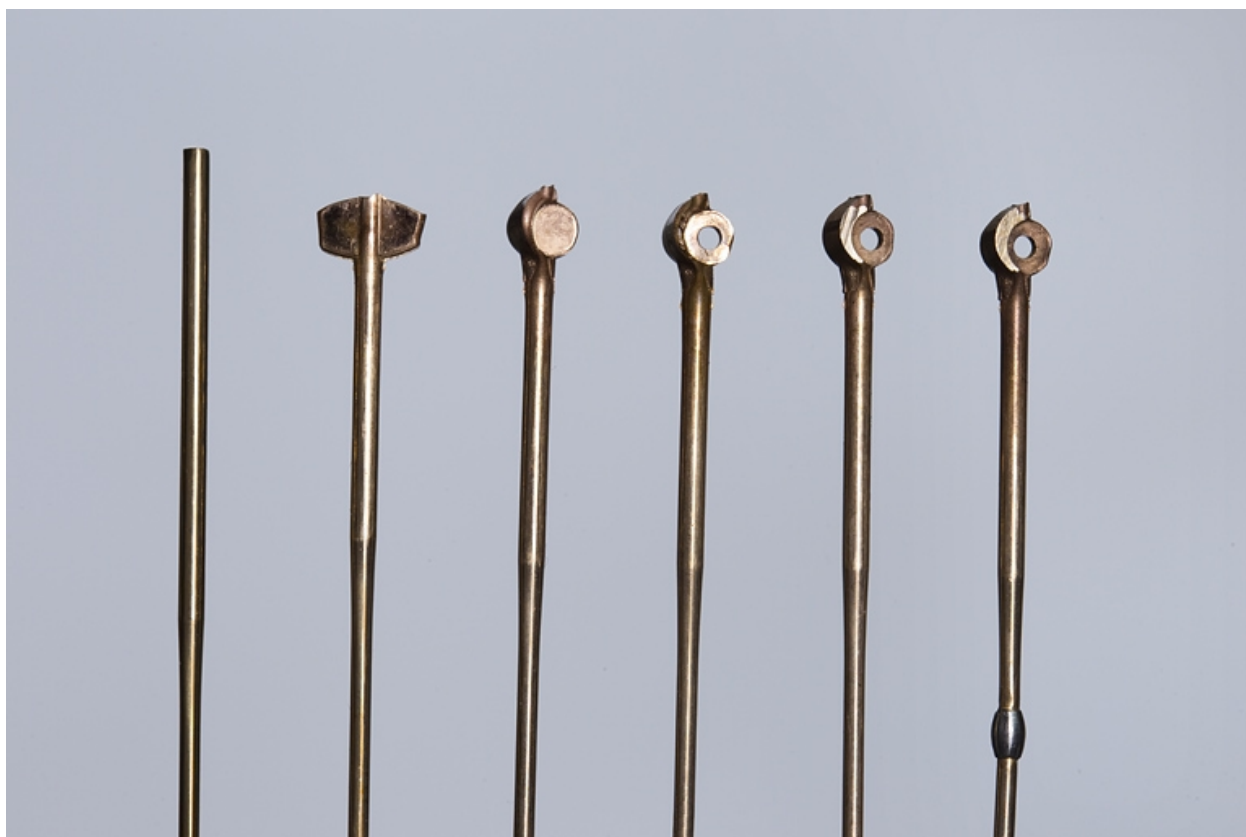
Branches de lunettes à différentes étapes de fabrication. De gauche à droite, fil de bronze après refoulement et talonnage, perçage de l'oeil, mise à la largeur du chapeau, fraisage de l'oeil et du talon, sertissage de l'enjoliveur.
