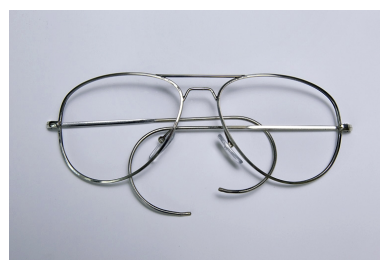
Monture de lunettes à branches cordées. La monture est en cours de fabrication : le nez et la barrette relient les deux cercles et chaque charnière est vissée sur
