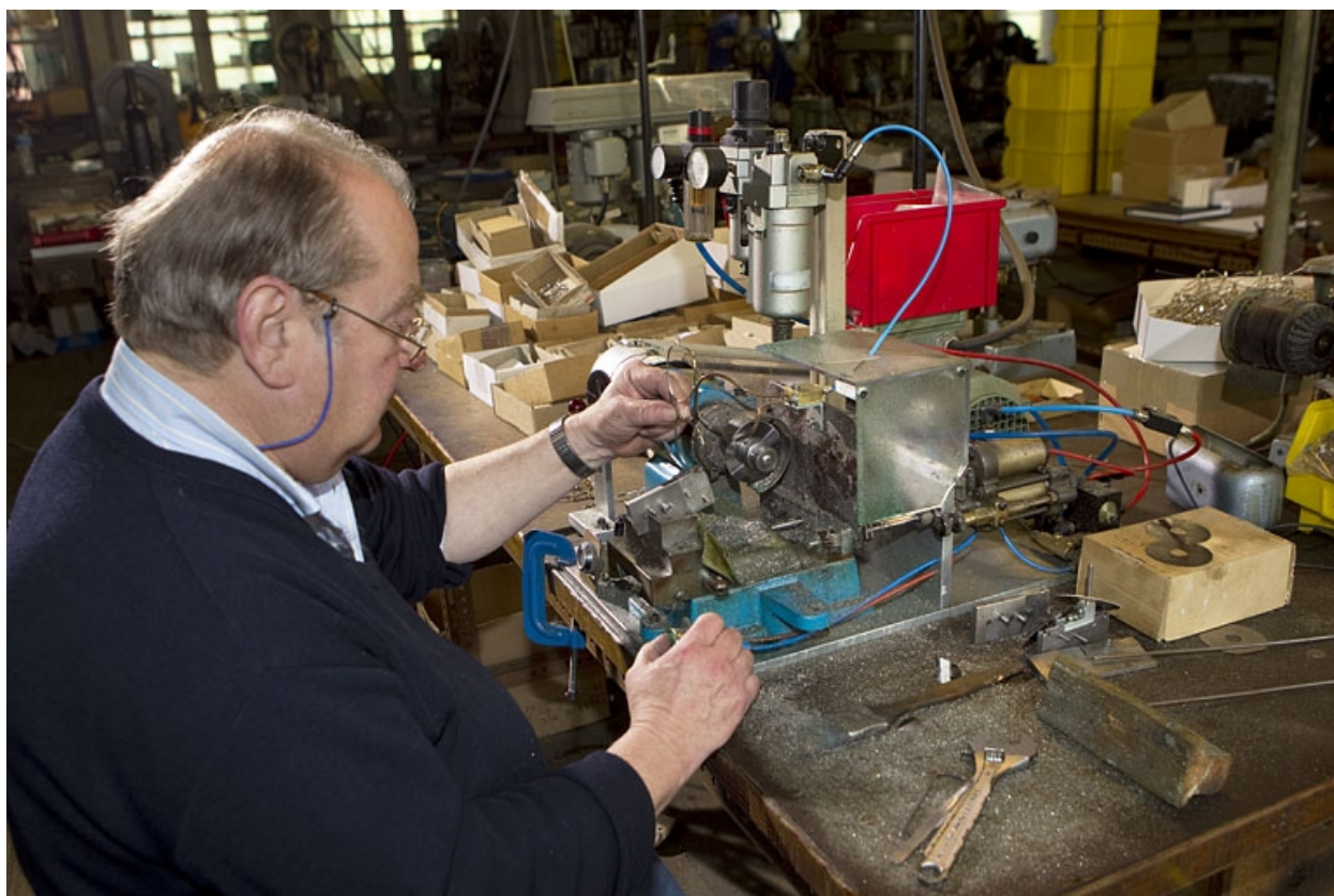
Sciage des tenons en deux (vue rapprochée).
