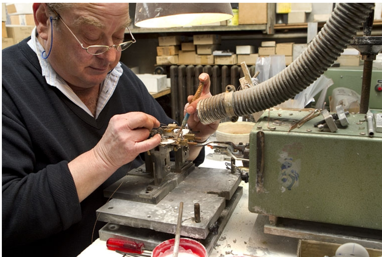
Soudage sur la machine à souder Himmel.
