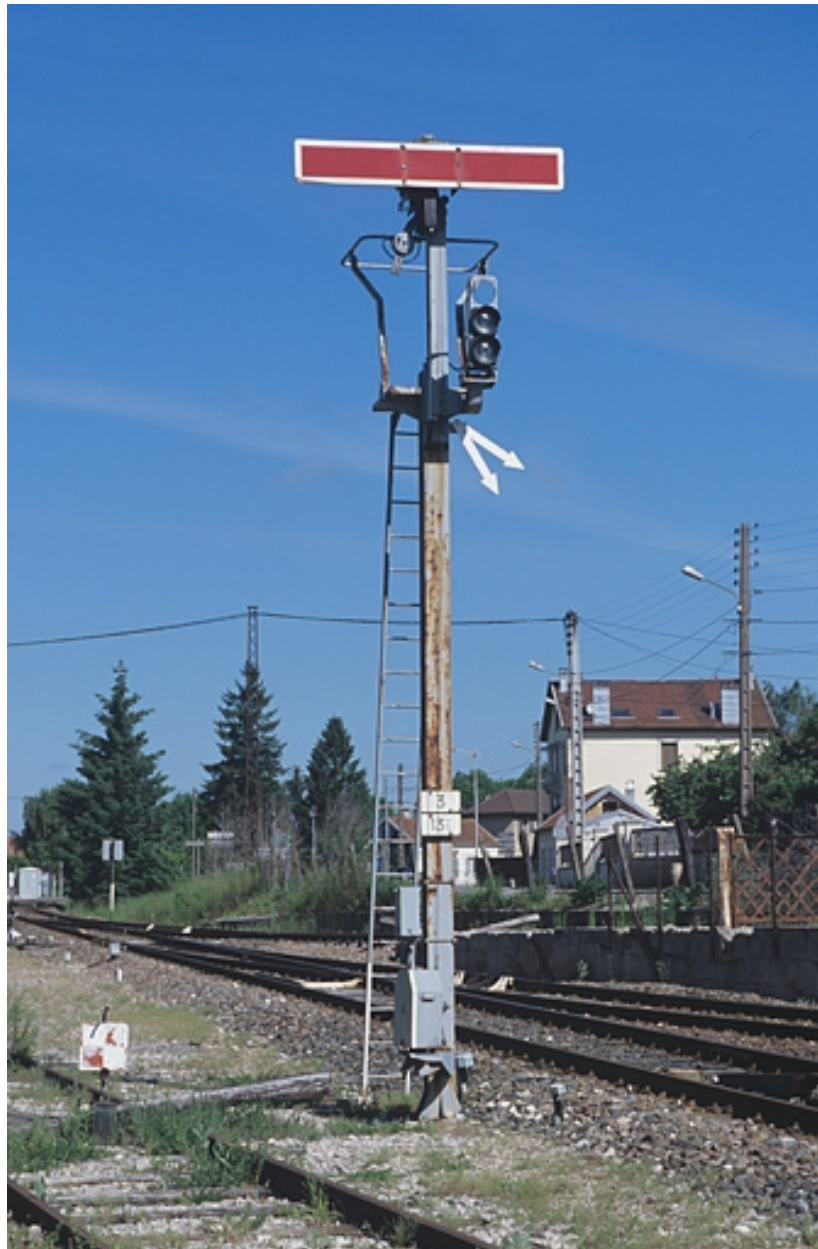
Gare de Champagnole : sémaphore côté Andelot-en-Montagne : vue d'ensemble, en position fermée.
