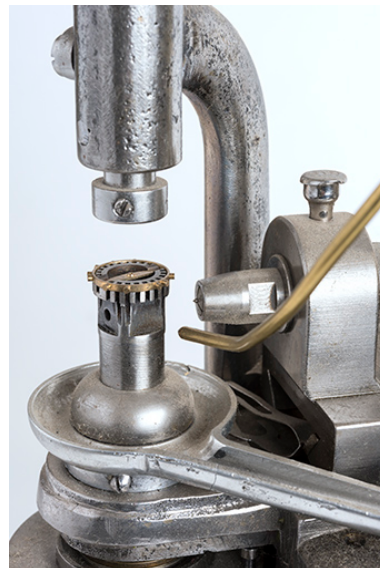
Support du balancier (fixation relevée), mèche (à droite) et système de lubrification (tuyau d'amenée et gouttière d'évacuation de l'huile). Un balancier achevé (il est muni de ses vis) a été posé sur le support. Phot. Sonia Dourlot IVR43_20162500481NUC4A
