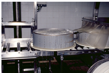
Moules remplies de caillé sortant du soutirage sous vide. Phot. Jérôme Mongreville IVR43_19953900240ZA
