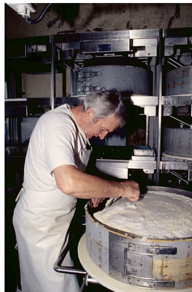
Insertion de la plaque de caséine. La plaque de caséine verte identifie la fromagerie d'origine du comté et mentionne sa date de fabrication. Phot. Jérôme Mongreville IVR43_19953900244ZA
