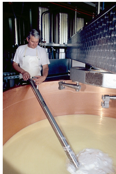
Soutirage sous vide. Phot. Jérôme Mongreville IVR43_19953900235ZA
