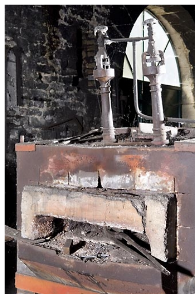
Atelier est. Détail de l'ouverture d'un four à gaz Thermidor. Phot. Jérôme Mongreville IVR43_20087000819NUC2A
