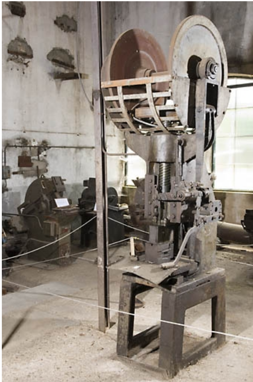
Atelier ouest. Presse à friction.
