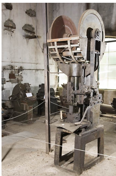
Atelier ouest. Presse à friction.
