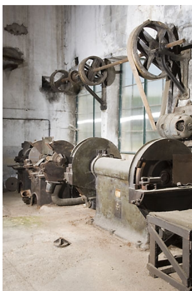
Atelier ouest. Tourets à 2 meules. Phot. Jérôme Mongreville IVR43_20087000850NUC2A
