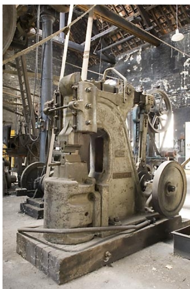
Atelier est. Martinet à ressorts de la Société de Constructions de Montbard. Phot. Jérôme Mongreville IVR43_20087000832NUC2A
