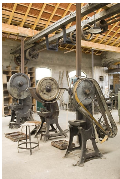
Atelier ouest. Presses "col de cygne".
