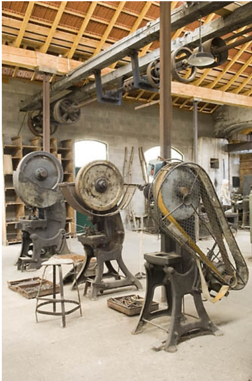
Atelier ouest. Presses "col de cygne".
