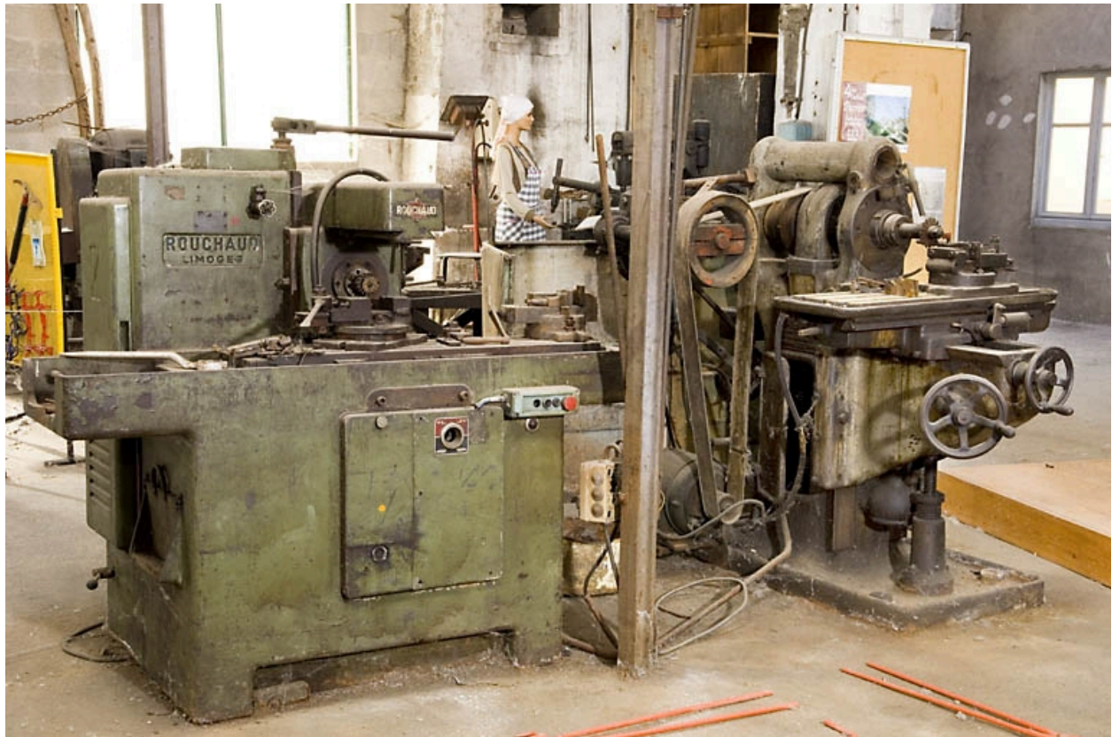
Atelier ouest. Fraiseuses Rouchaud et Gildemeister and Co.
