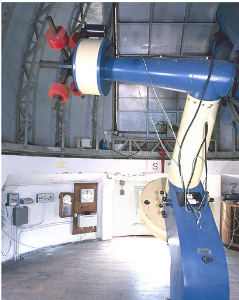
Partie contrepoids munie de quatre masses.
