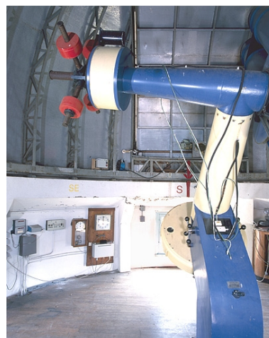
Partie contrepoids munie de quatre masses. Phot. Jérôme Mongreville IVR43_20032501106XA
