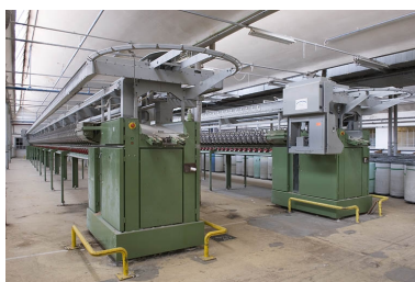
Deux lignes de continus à filer Schlafhorst, modèle Autocoro. Phot. Jérôme Mongreville IVR43_20097000738NUC2A
