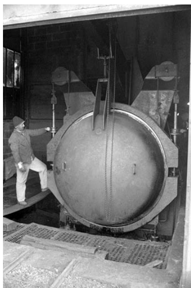
Fermeture de l'autoclave. Phot. Laurent Poupard IVR43_19883900335Z
