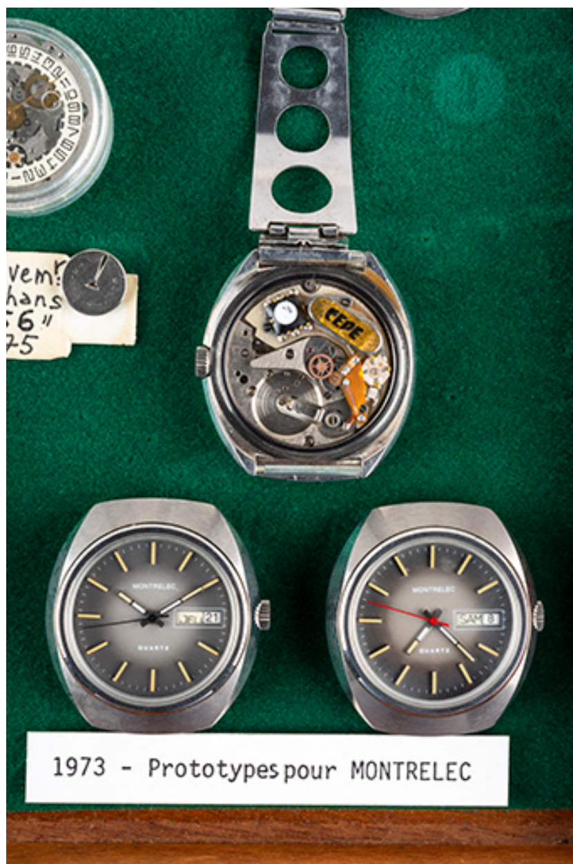
Prototypes de montre à quartz étudiés par le Cetehor pour Montrelec (1973).
