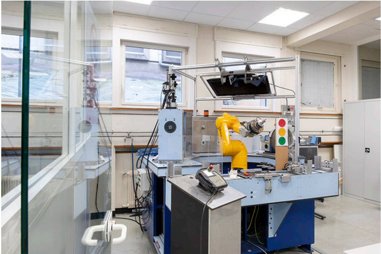
1er étage de soubassement, polissage : polissage robotisé.
