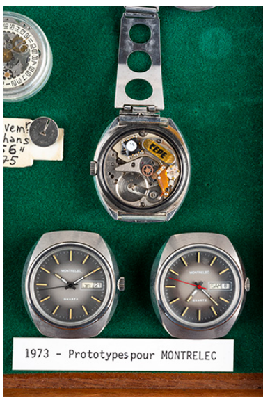
Prototypes de montre à quartz étudiés par le Cetehor pour Montrelec (1973). Phot. Sonia Dourlot IVR43_20192500300NUC4A
