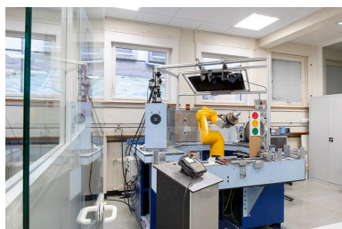
1er étage de soubassement, polissage : polissage robotisé. Phot. Sonia Dourlot
