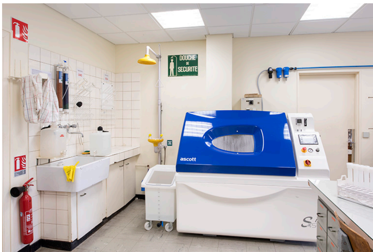
1er étage de soubassement, laboratoire de chimie : machine à brouillard salin et paillasse.
