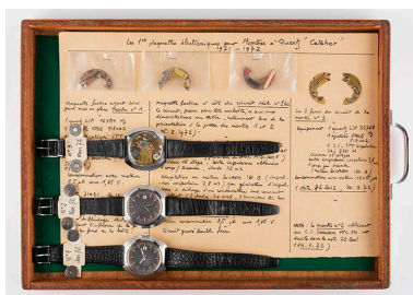
Prototypes de montres à quartz du Cetehor, présentés en 1972 : n° 1 (janvier), n° 2 (février) et n° 3 (mars). Phot. Sonia Dourlot IVR43_20192500301NUC4A
