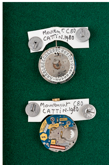
Modules à quartz Cattin C 80 (1980), étudiés par le Cetehor. Phot. Sonia Dourlot IVR43_20192500306NUC4A
