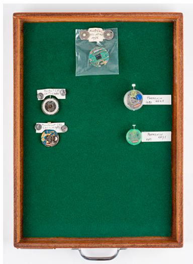
Modules à quartz étudiés par le Cetehor : Montrelec MTC-61 NU (1976), Cattin C 80 (1980), Parenin 6641 (1980) et 6871 (1981). Phot. Sonia Dourlot IVR43_20192500305NUC4A
