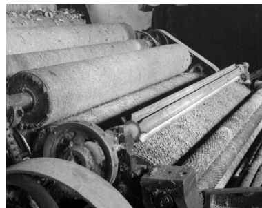
Détail du cylindre briseur. De droite à gauche, rouleaux alimentaires, cylindre briseur puis cylindres cardes de l'avant-train. Phot. Yves Sancey IVR43_19943901526X
