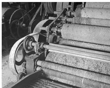
Détail du cylindre briseur. De gauche à droite, rouleaux alimentaires, cylindre briseur puis cylindres cardes de l'avant-train. Phot. Yves Sancey IVR43_19943901527X
