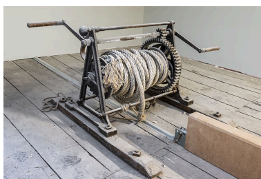
Treuil (désaffecté) du lustre de la salle. Phot. Jérôme Mongreville IVR43_20223900263NUC4A
