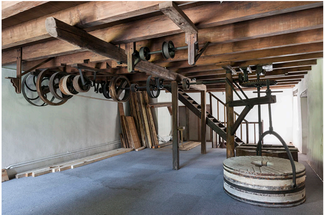
Premier étage. Transmission par poulies et meules.
