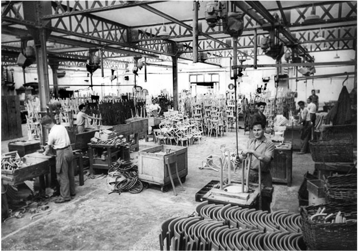
Atelier de montage des chaises en bois courbé. Photographie, coll. part. F&S Messagier, 1952.
