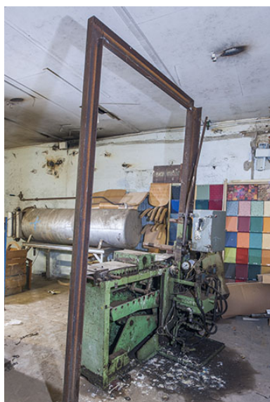
La cintreuse et son portique. Phot. Jérôme Mongreville IVR43_20132500224NUC4A
