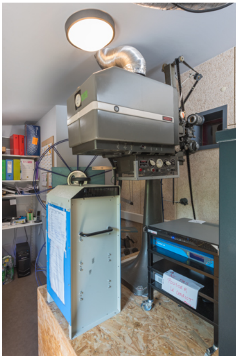
Projecteur Fedi XV T et son redresseur Irem N3-X75DM, depuis l'entrée de la cabine.
