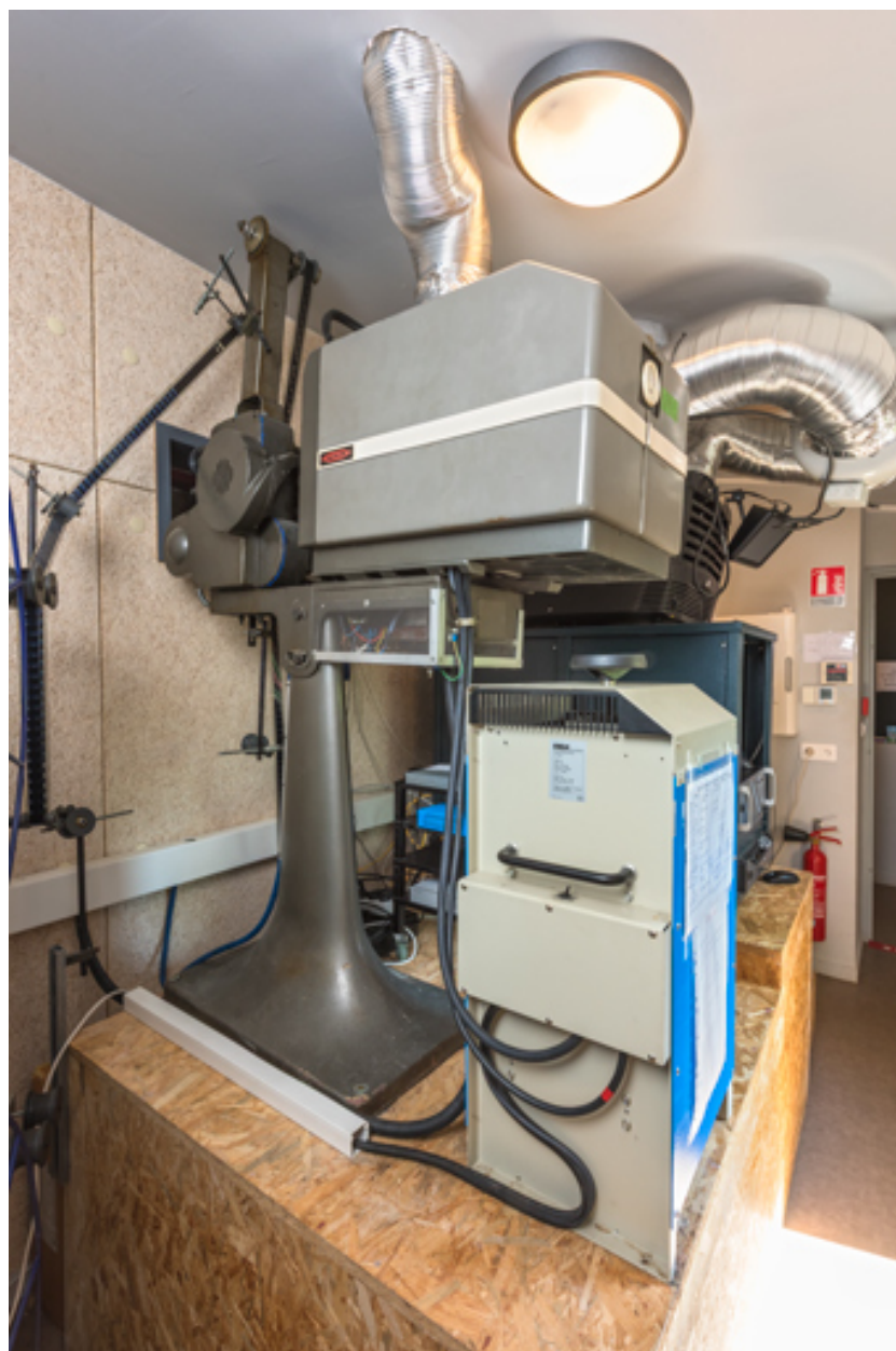
Projecteur Fedi XV T et son redresseur Irem N3-X75DM, depuis le fond de la cabine.
