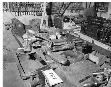
Machine à aplatir. Phot. Jérôme Mongreville IVR43_19963901050X
