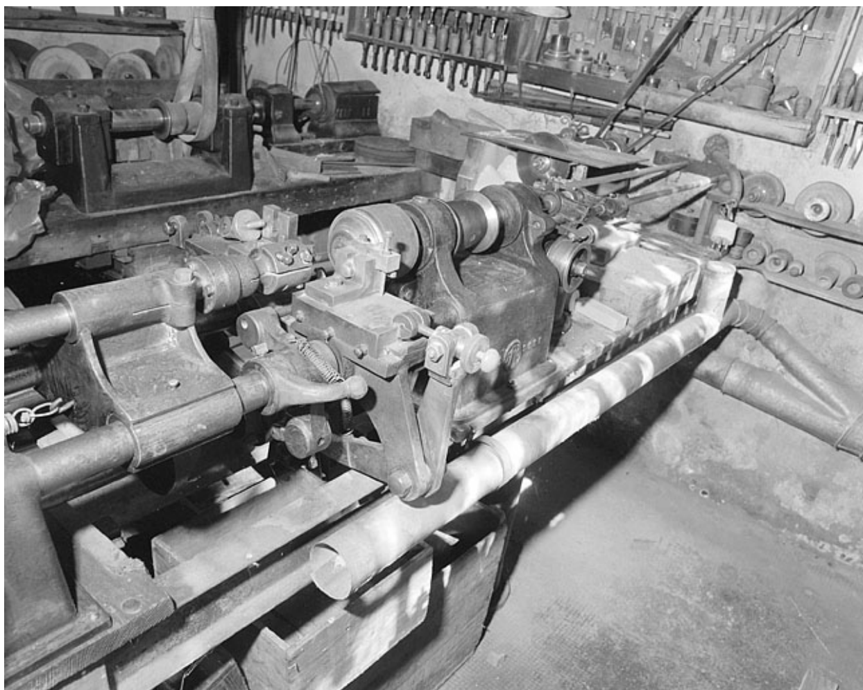
Tour automatique, permettant de travailler la galalithe, datant de 1920 environ.
