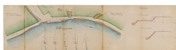
Construction d'un perré et d'une rampe d'abreuvoir à Jallanges. [Plan et profils]. 10 novembre 1859. Phot. Thierry Kuntz IVR26_20217100017NUC4A
