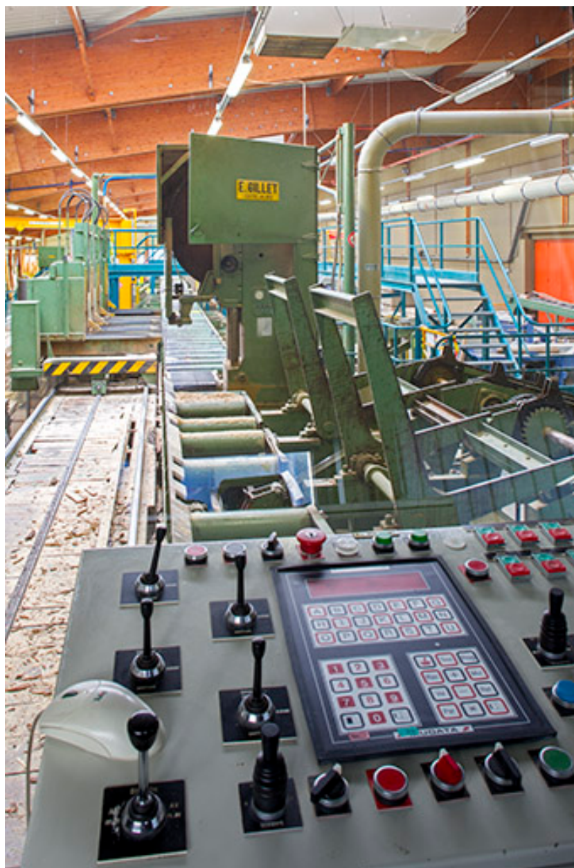
Scierie : machine à commande numérique pour débitage.
