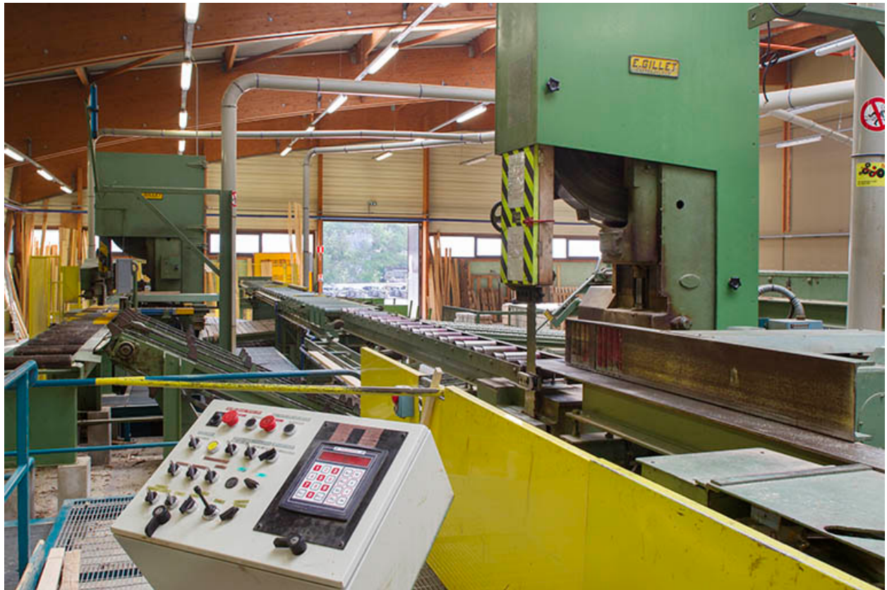
Scierie : poste de commande automatisé.
