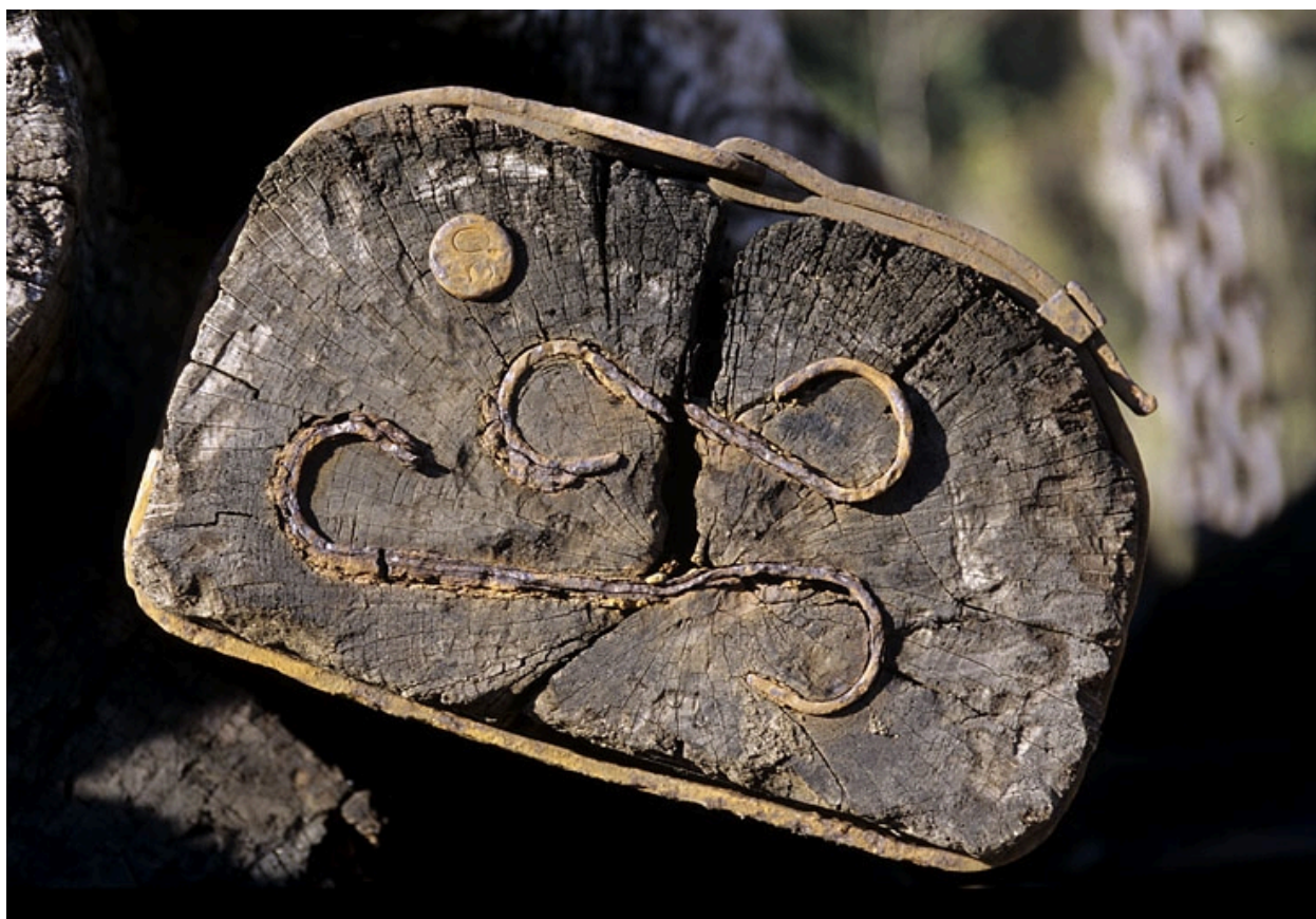
Extrémité d'une traverse avec frettage Delor, eses et clou.
