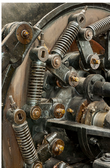
Mécanisme d'orientation des pales. Phot. Jérôme Mongreville IVR43_20152501788NUC4A
