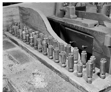
Jeu d'embouts de tailles différentes posés sur l'établi. Phot. Jérôme Mongreville IVR43_20022500465X
