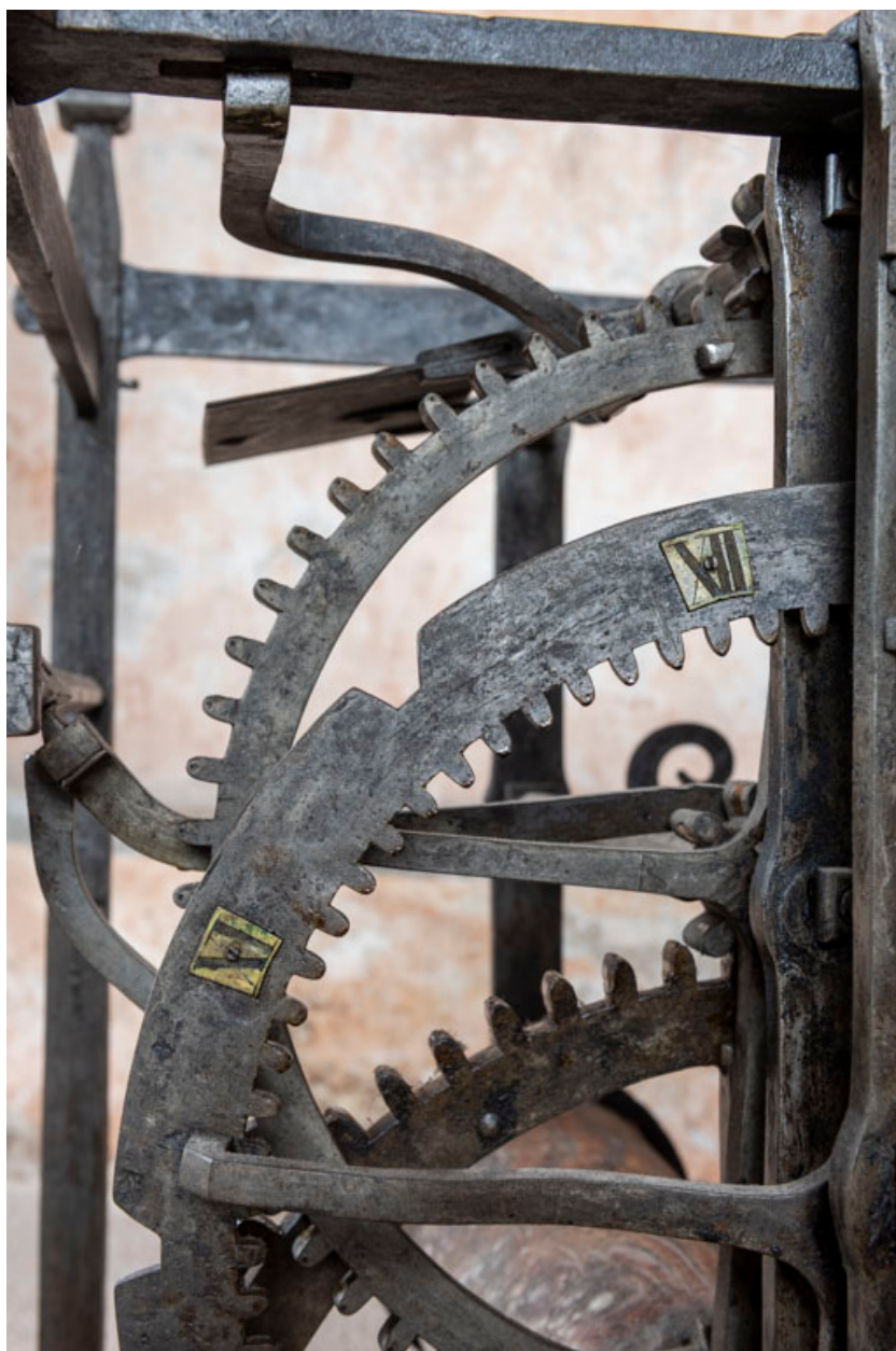
Corps avant gauche (sonnerie des heures) : détail de la roue de compte.
