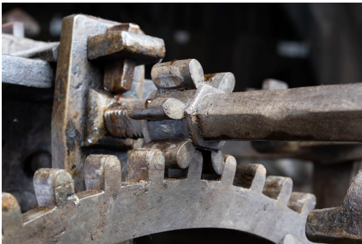
Roue dentée et pignon : détail de la denture.
