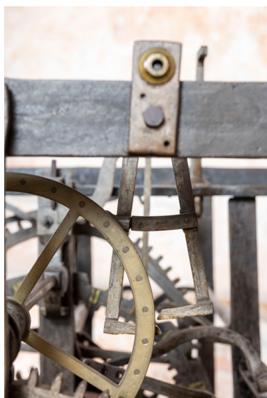
Echappement à chevilles : roue d'échappement au premier plan, en avant de l'ancre.
