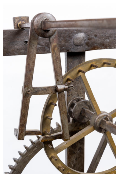
Echappement à chevilles : ancre et roue d'échappement.
