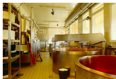
Intérieur de l'atelier de fabrication du comté. Cuves à droite, soutirage sous vide à gauche. Phot. Jérôme Mongreville IVR43_19943901235ZA
