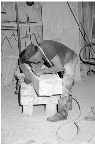
Taille de la pierre au burin pneumatique (J. Faccenda). Phot. Laurent Poupard IVR43_19893900176Z
