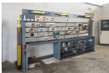
Matériel pédagogique d'hydraulique. Phot. Mary Ruffinoni IVR43_20137000674NUC4A
