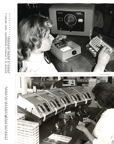
Société Yema : appareils de contrôle d'amplitude et de comptage automatique des spiraux, photogr., s.d. [vers 1970]. IVR43_20212500116NUC2A
