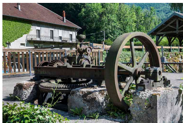
Engrenages et volant de transmission de la turbine. Phot. Jérôme Mongreville IVR43_20152501488NUC4A
