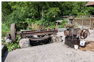
Transmission à l'aplomb de la turbine (à gauche) et régulateur Goulut-Borne. Phot. Jérôme Mongreville IVR43_20152501489NUC4A
