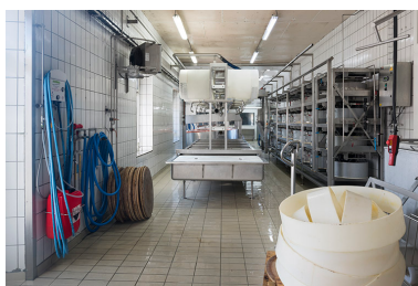
Atelier de fabrication : banc de soutirage et installation de pressage. Phot. Sonia Dourlot IVR43_20162501326NUC4A
