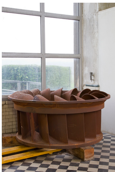
Turbine Francis déposée. Phot. Yves Sancey IVR43_20122502058NUC2A
