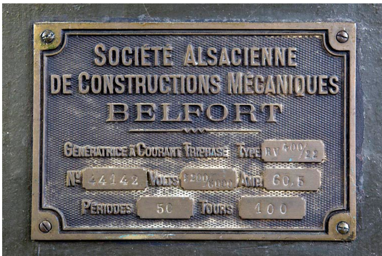
Plaque de constructeur d'un alternateur SACM.
