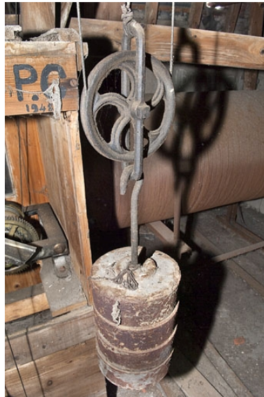
Un des poids actionnant les fils et l'une des inscriptions peintes sur la caisse. Phot. Jérôme Mongreville IVR43_20112502912NUC2A
