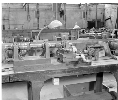
Déplacement de la troisième main vers la gauche : la mèche perce la tige (atelier principal). Phot. Jérôme Mongreville IVR43_20022500637X
