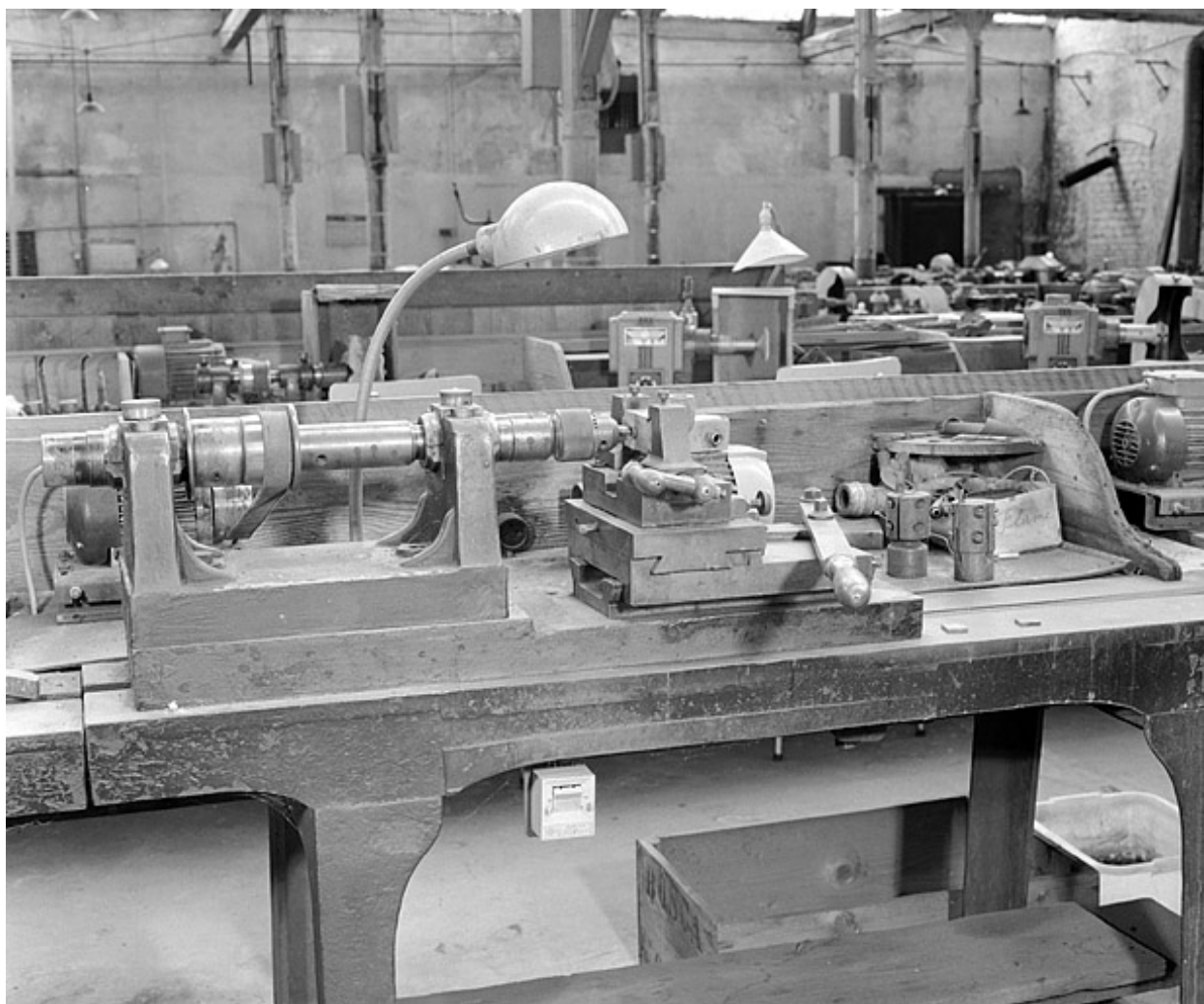
Déplacement de la troisième main vers la gauche : la mèche perce la tige (atelier principal).
