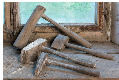
Atelier de fabrication : maillets de dinandier. Phot. Sonia Dourlot IVR43_20172501728NUC4A
