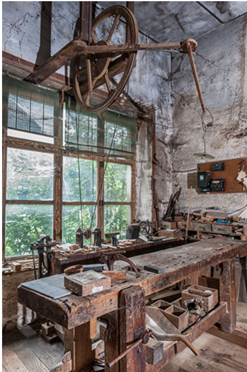
Menuiserie Baudiquey (Sancey-le-Long). Etabli et tour à pédalier.
