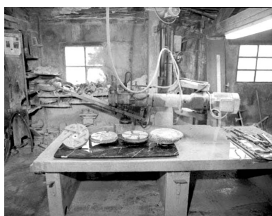
Polissoir à genouillère et ses plateaux. Plateaux à revêtement en carborandum, en acide oxalyque et en cordes. Phot. Yves Sancey IVR43_19933900329X
