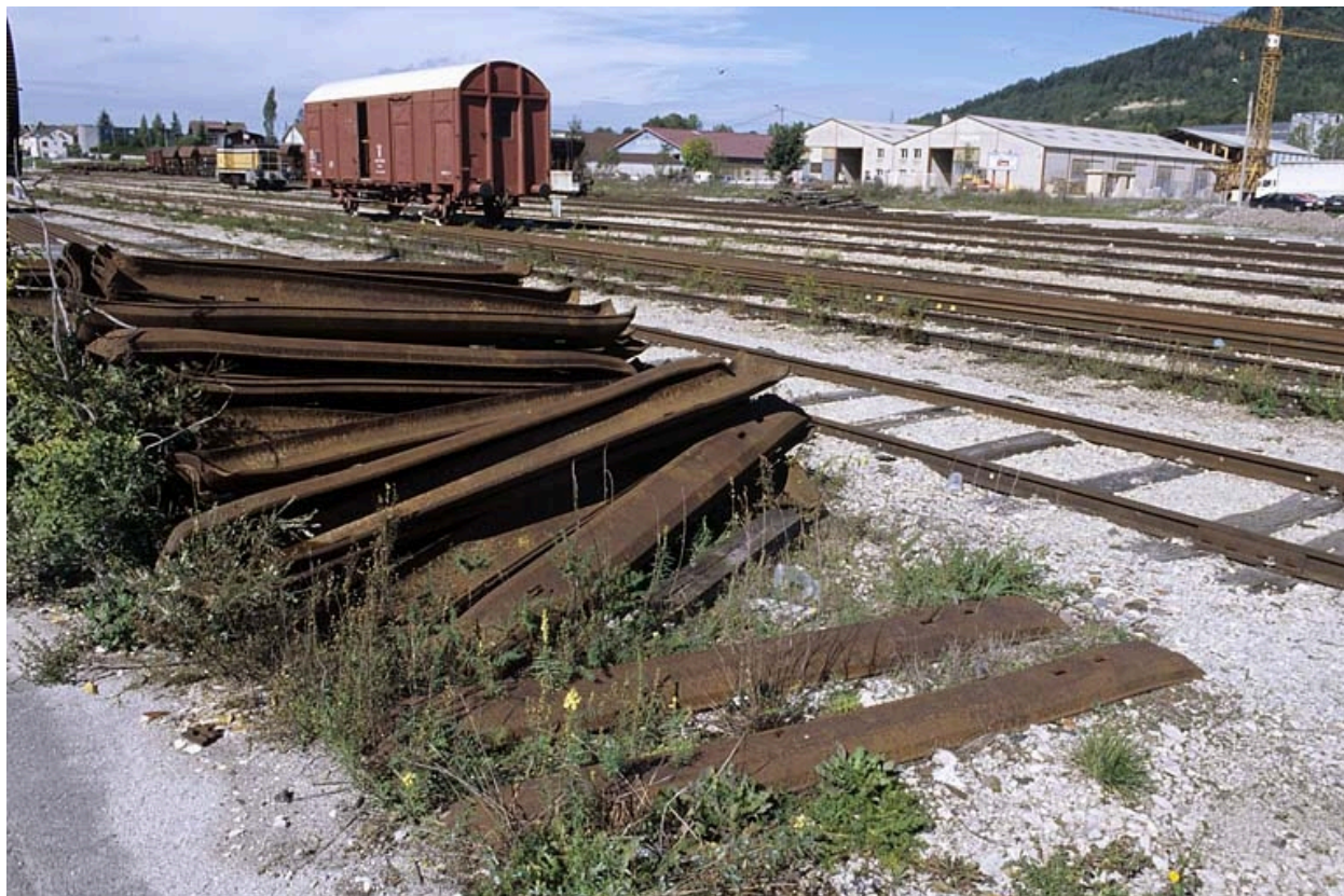
Traverses métalliques réformées stockées en gare de Champagne.
