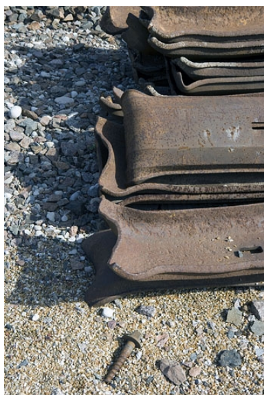
Extrémité de traverses simples (gare de Champagnole). Phot. Yves Sancey IVR43_20083900884NUC2A
