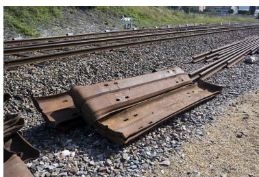
Traverses doubles stockées en gare de Champagnole. Phot. Yves Sancey IVR43_20083900882NUC2A
