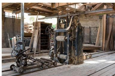
Atelier de fabrication : châssis de scie
