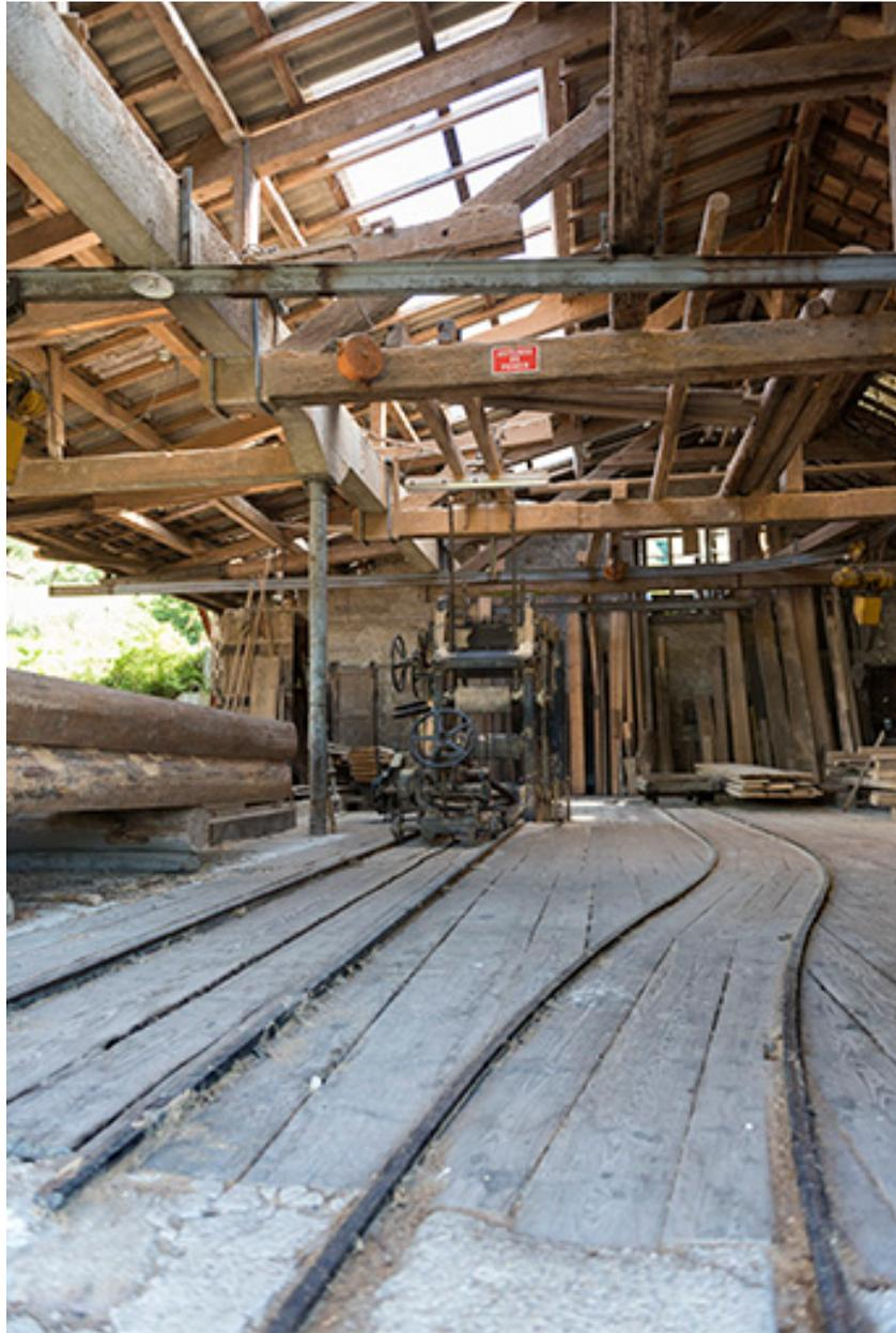
Atelier de fabrication : châssis de scie Socolist et rails.
