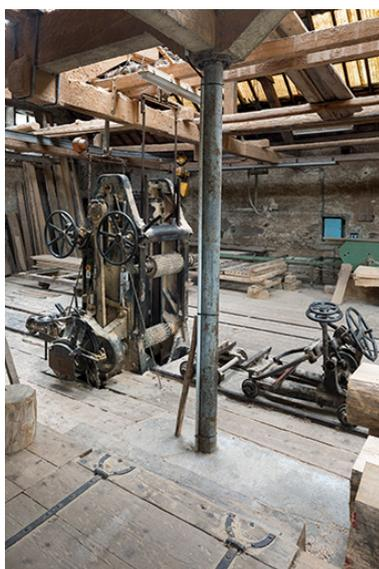
Atelier de fabrication : châssis de scie
