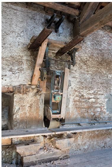
Atelier de fabrication : scie circulaire à balancier Guillet et Fils.
