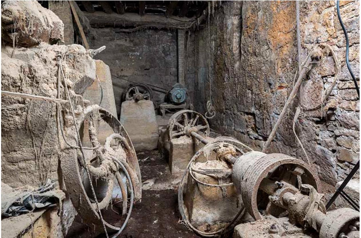
Atelier de fabrication, sciurier : transmission de la turbine.
