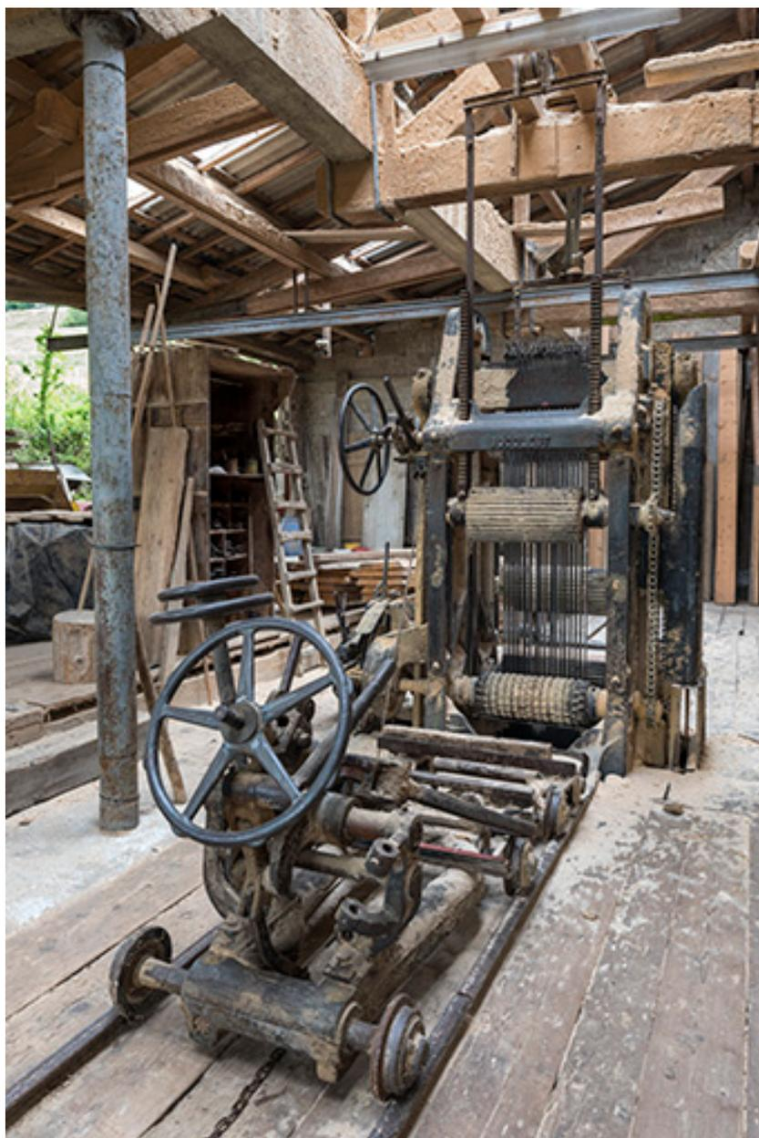
Atelier de fabrication : châssis de scie Socolest.
