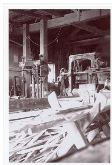
[Châssis de scie à coulisses en bois, à gauche, et petit châssis Socolest], années 1950.
