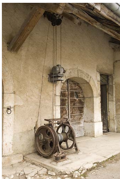
Déchargeuse : vue d'ensemble du treuil. Phot. Jérôme Mongreville IVR43_20082500829NUC2A
