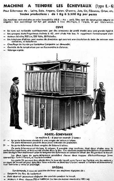
[Machine à teindre les écheveaux Libbrecht type E.6 vue de trois quarts arrière, porte-écheveaux sorti].
