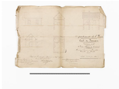
"Maisons éclusières de Vincelottes, Vincelles et Rivotte". Elévation, plan et coupe. (VNF-direction territoriale Centre-Bourgogne ; subdivision de Corbigny) Phot. Thierry Kuntz IVR26_20138900106NUC4A
